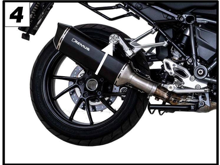
Montieren Sie die Federn sowie die mitgelieferte Klappenabdeckung mit den originalen Schrauben der Hitzeschutzabdeckung. Positionieren Sie den Schalldämpfer und ziehen alle Schrauben fest (Abb. 5 / 6).
