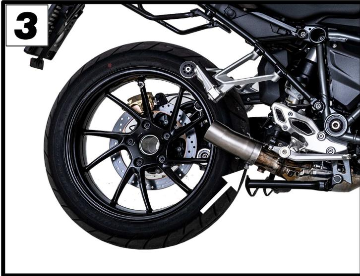
Montieren Sie den REMUS Sportschalldämpfer am Motorrad und ziehen Sie die Schrauben leicht an. (Abb. 4)
